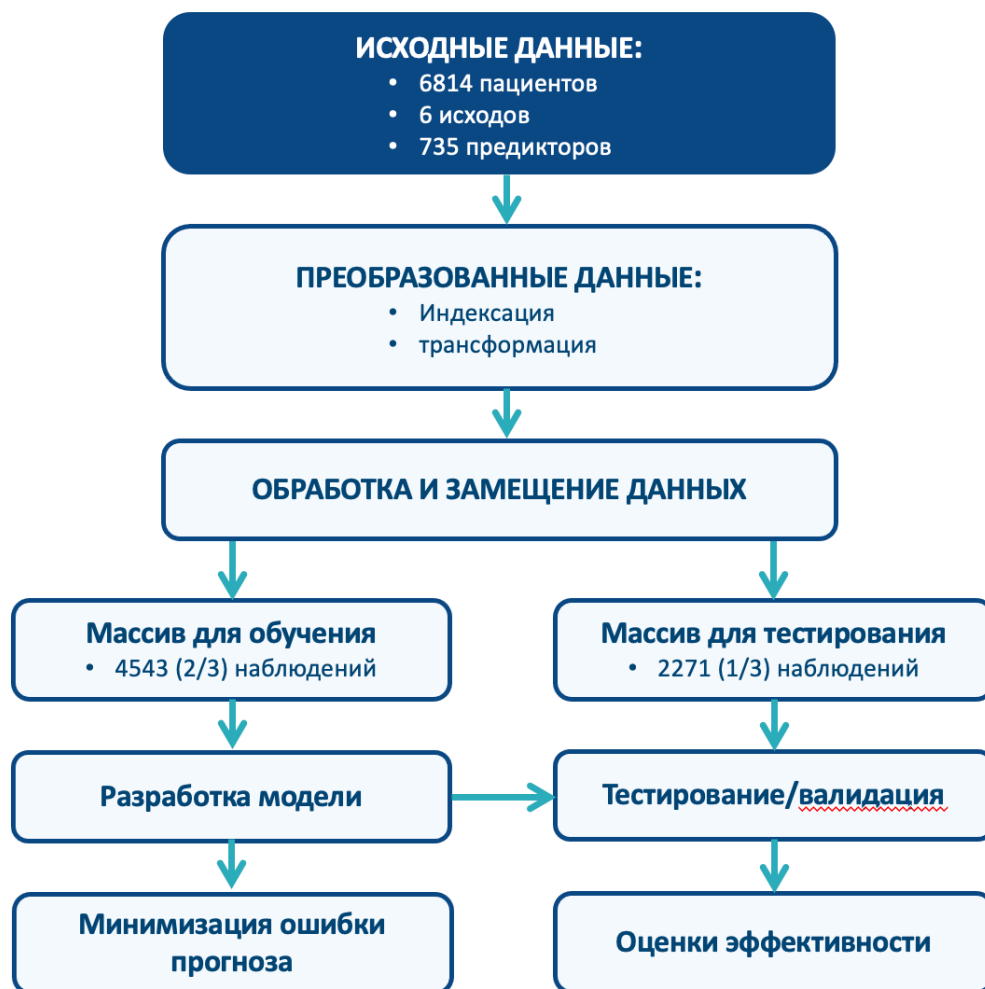
Рисунок 3. Процесс подготовки данных и проведения машинного обучения с целью создания модели (алгоритма) искусственного интеллекта
