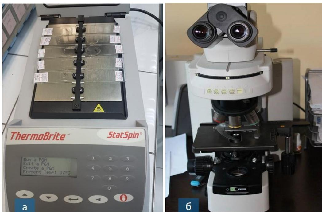
Рисунок 2.3 – Лабораторное оборудование: а – гибридайзер ThermoBrite (программируемая система для автоматического выполнения денатурации и гибридизации); б – цифровой микроскоп со встроенным фотоаппаратом Olympus BX45
