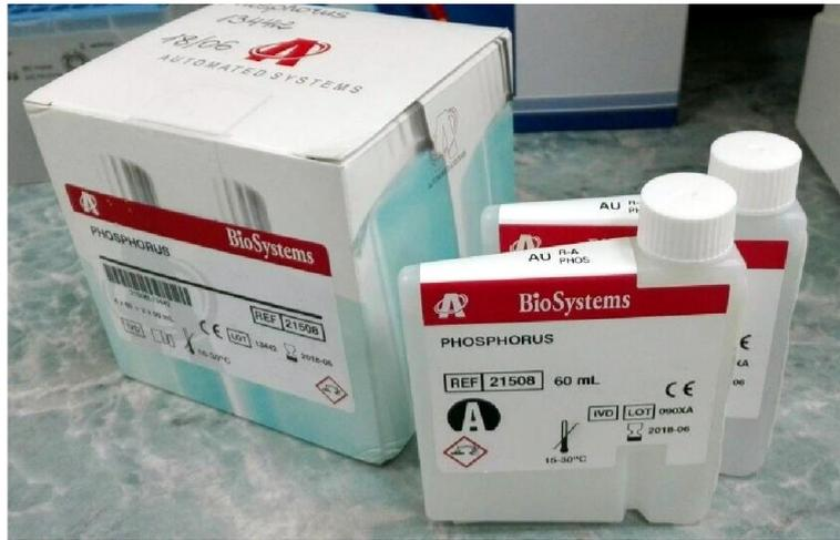
**Рисунок 2.14** – Набор реактивов с молибдатом аммония фирмы BioSystems S.A. (Испания)
