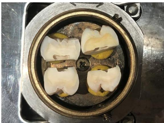
**Рисунок 2.6** – Загрузка образцов для электронной микроскопии
