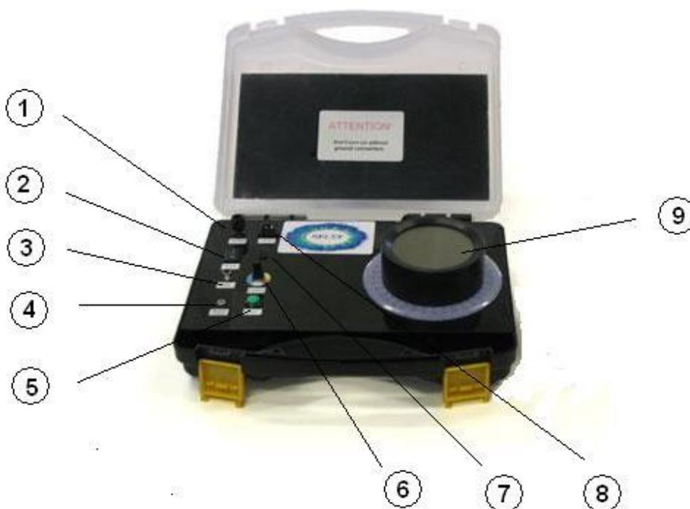
**Рисунок 2.5** – Сканер КЭЛСИ для регистрации свечения в высокочастотном электромагнитном поле
