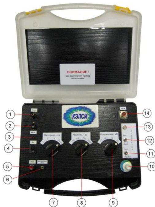
**Рисунок 2.10** – Элементов управления сканера КЭЛСИ-M-2011
