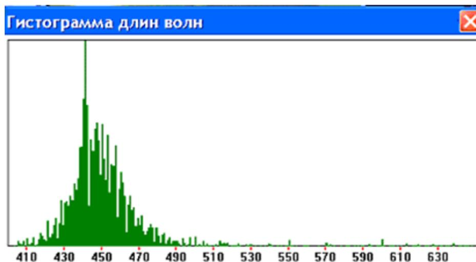
**Рисунок 2.8** – Гистограмма длин волн свечения объекта в высокочастотном электромагнитном поле
